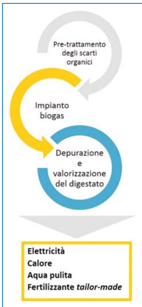
Figura 2 - Catena produttiva della bioraffineria di lavorazione di materiali di scarto a Seul, Corea.
